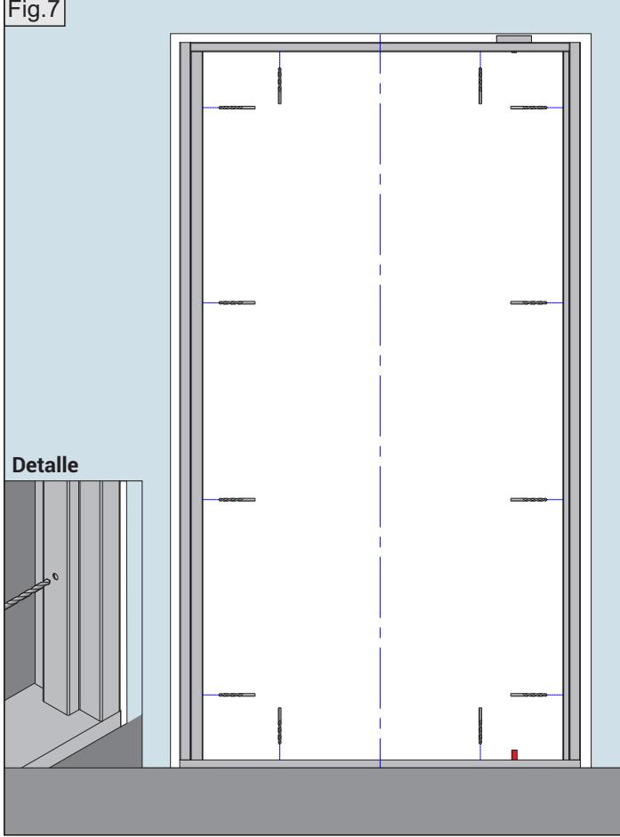
6- Una vez fijado el marco colocar el revestimiento del piso. El umbral debe quedar dentro de la carpeta y sobre este colocar el revestimiento elegido, teniendo en cuenta que se debe realizar el corte en el lugar donde se encuentra el eje de pivot del umbral, dejándolo descubierto.
