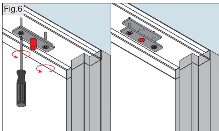
**Nota:** Si desea mejorar el anclaje puede colocar tacos de madera en el espacio vacío del marco por donde realizo las perforaciones. De esta forma minimizará la deformación del marco al ajustarlo.
