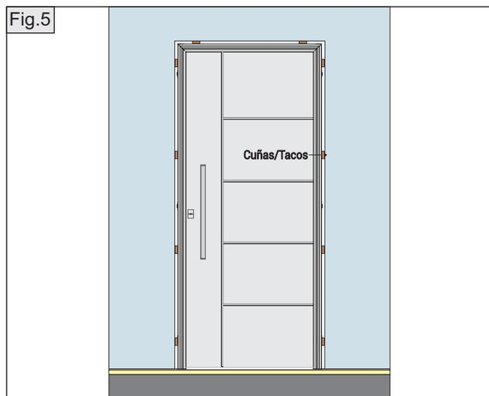
**Importante:** Compruebe cierres y cerradura, controle la separación de la hoja de puerta respecto del nivel de piso. Prever que esta distancia sea aproximadamente entre 5 a 8mm Fig.3b, ya que de no respetarse la hoja quedara muy elevada o rozando el piso sin posibilidad de corrección.
