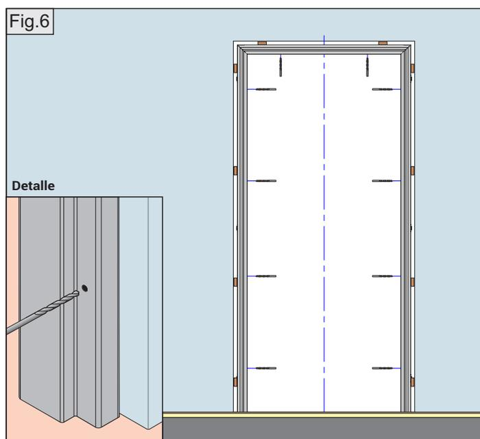
**Nota:** Antes de la fijación con tornillos controle nuevamente, el plomo del marco, el nivel, la escuadra, la separación entre las jambas del marco de manera que se mantenga la misma en toda la altura. Para preservar las luces de fabrica entre la hoja y el marco.
