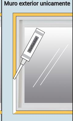
9- Proceda a sellar el perímetro exterior por el canal previamente generado, con silicona neutra o con un sellador equivalente.
